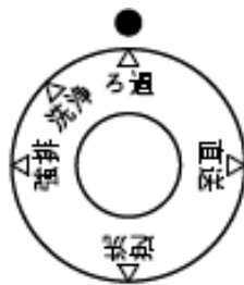
左側濾過水出口
